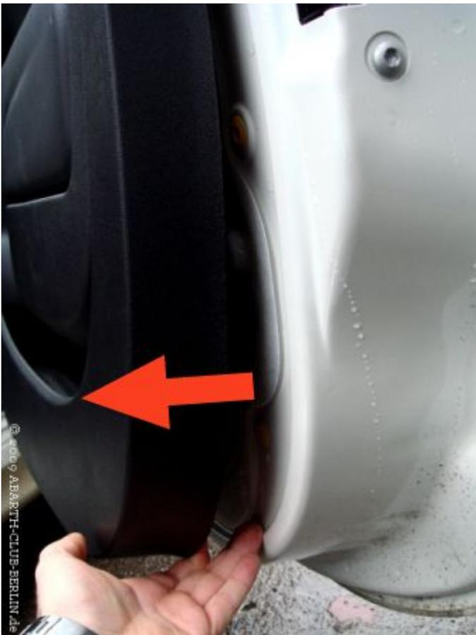
Wenn alle Klips gelöst sind hängt die Türverkleidung nur noch im oberen Bereich am Fenster in der Führung. Die Verkleidung vorsichtig in Pfeilrichtung anheben.
