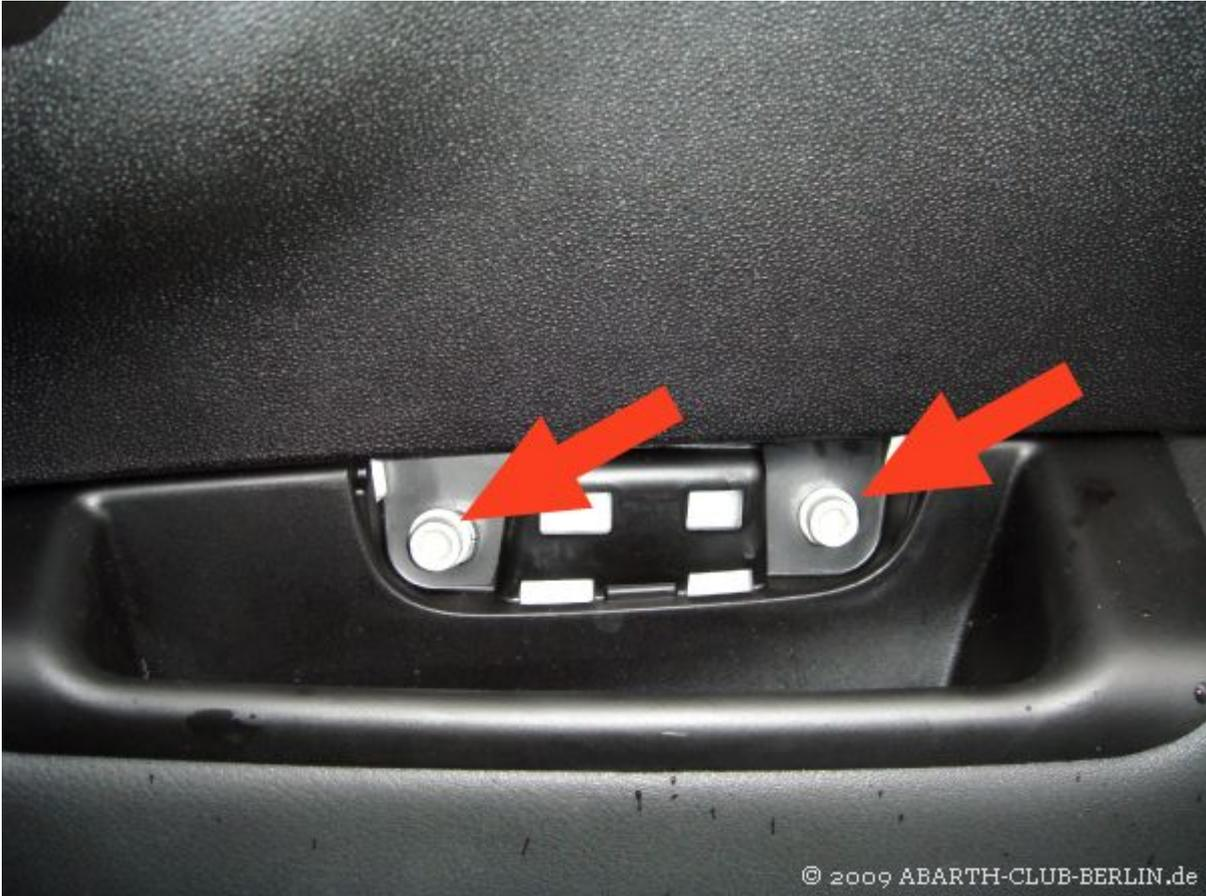
Mit dem geeigneten Inbusschlüssel lassen sich die Schrauben leicht herausschrauben.
